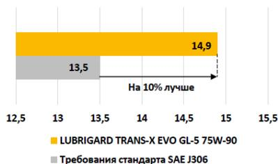
Коррозийное воздействие на медную пластину (3 часа при 120 °С)
